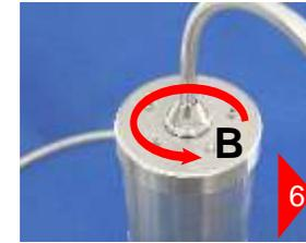
**6** Wasserhahn schließen, Gerät möglichst in die Küchenspüle stellen. Gehäusedeckel (B) demontieren, dazu diesen gegen den Uhrzeigersinn drehen und abnehmen.
