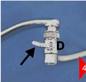
**4** Auslauf (F) über Spülbecken positionieren, Hebel am Umschaltventil (D) in waagerechte Position bringen, Wasserhahn öffnen. Wasser 5-7 min durch den Filter fließen lassen. Dabei wird die Filterpatrone aktiviert und produktionsbedingt vorhandener Aktivkohlestaub ausgespült. Das ist normal und unbedenklich.
