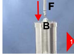
**1** Auslauf (F) in den Gehäusedeckel (B) fest bis Anschlag (Dichtringe nicht mehr sichtbar) einstecken. Falls schwergängig: Dichtringe anfeuchten oder mit Silikonspray benetzen
