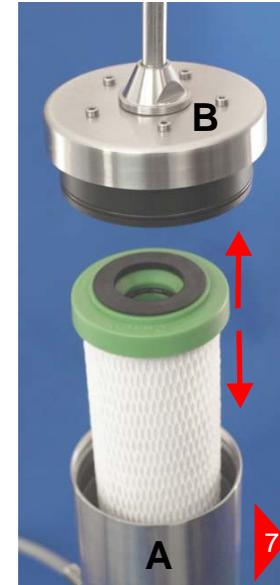
**7** Gehäusedeckel (B) senkrecht nach oben abnehmen, gebrauchte Filterpatrone nach oben entnehmen, neue Filterpatrone von Schutzfolie befreien mit der Auslaufseite (Loch in der Mitte des grünen Deckels) nach oben mittig in das Gehäuseunterteil (A) stellen.
