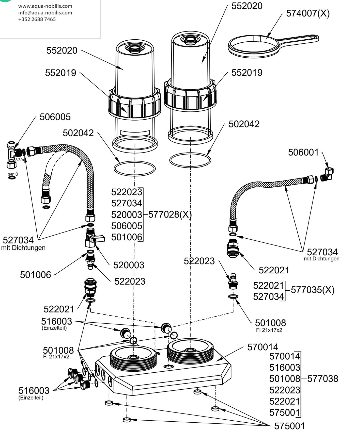
**Achtung:** Alle Gewindeverbindungen ohne eingezeichnete Dichtung mit Gewindedichtpaste eindichten.
