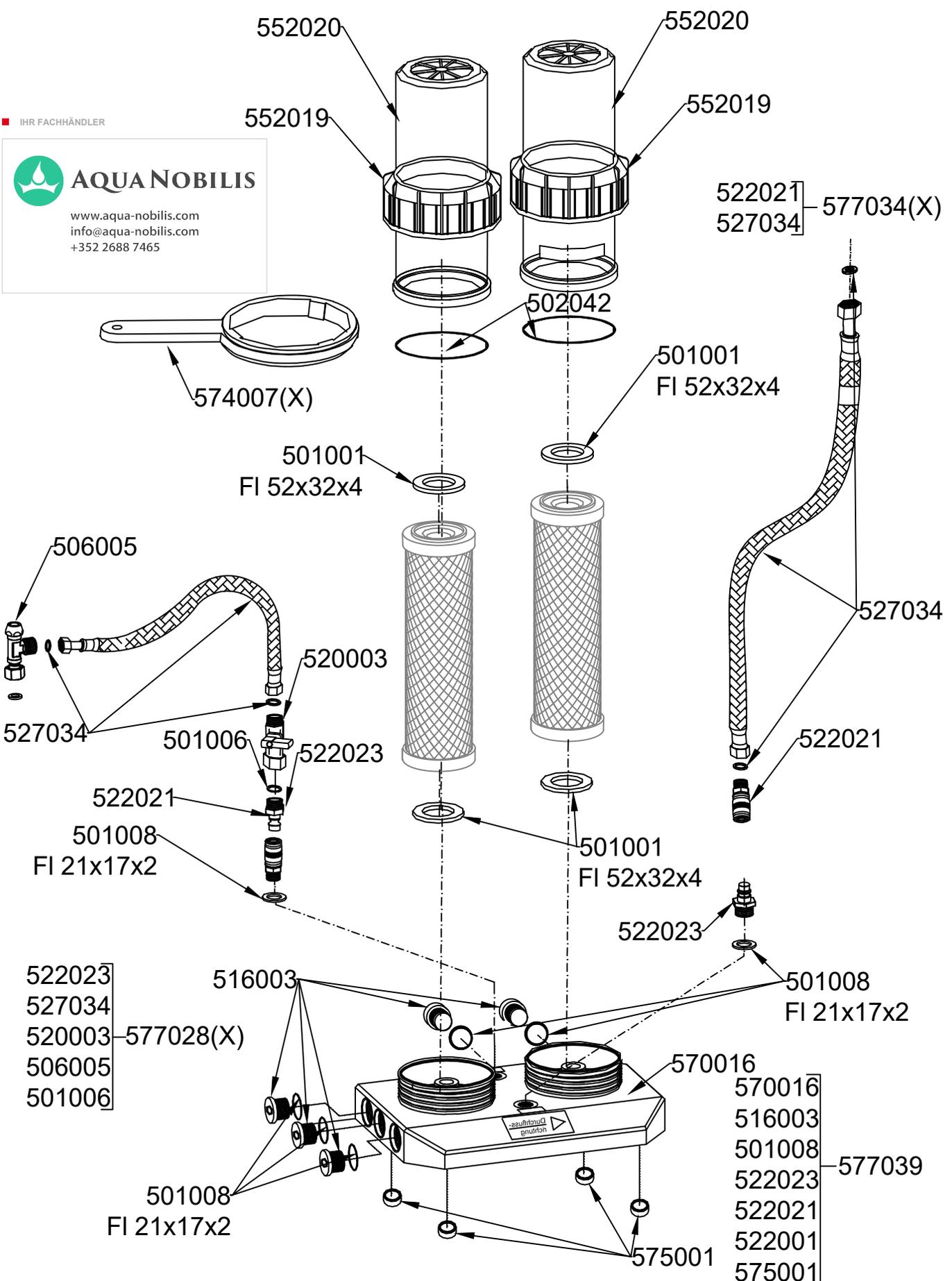
**Achtung:** Alle Gewindeverbindungen ohne eingezeichnete Dichtung mit Gewindedichtpaste eindichten.
